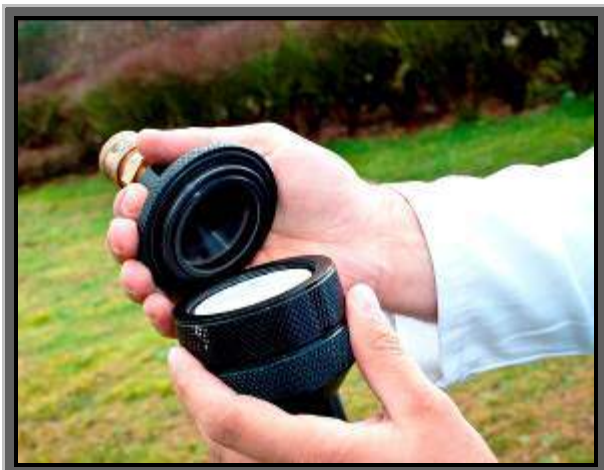
Figure 19 : Relevé d'un filtre atmosphérique par l'AFCN
