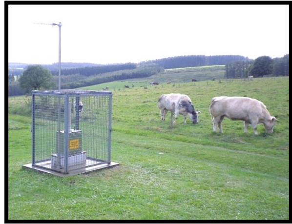
Figure 21 : Station de mesure des rayonnements gamma ambiants, implantée à Bourseigne-Neuve près du site de Chooz
