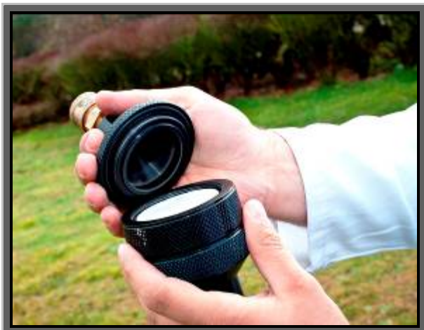
Figure 19 : Relevé d'un filtre atmosphérique par l'AFCN
